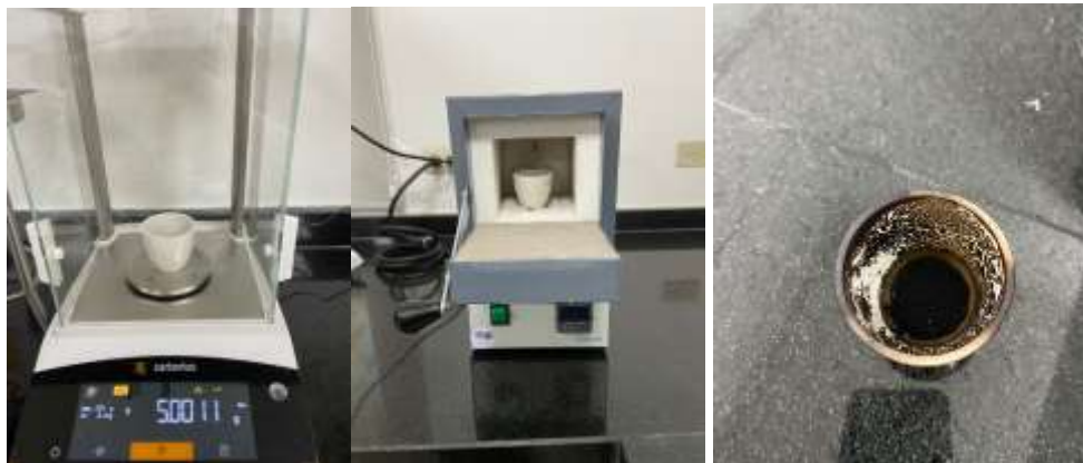
Determinación de contenido de materia orgánica en la muestra de balanceado
