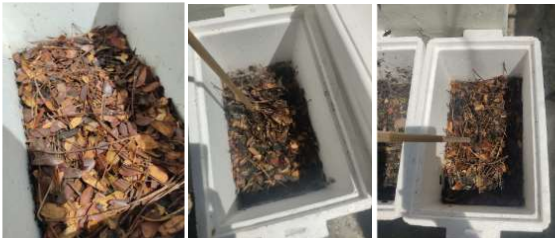
Monitoreo de temperatura, volteos y humedecimiento de las tres composteras (Control, Balanceado 1 y Balanceado 2).
