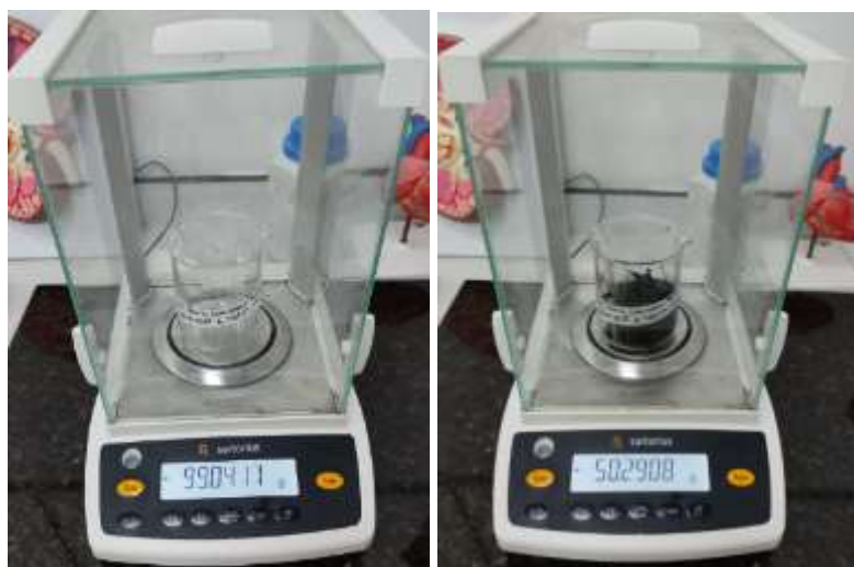
Monitoreo de humedad en compost de 3 composteras (Control, Balanceado 1 y Balanceado 2)
