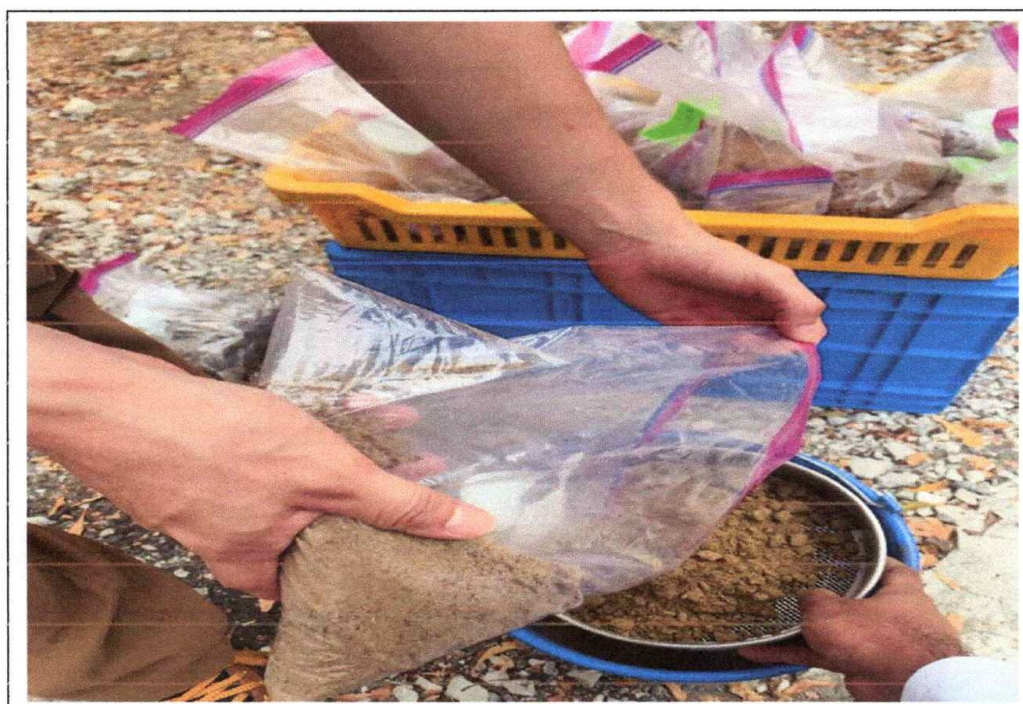
Uso del tamis 2.0mm para separacion de piedras y raices de la tierra que sera sometida a analisis
