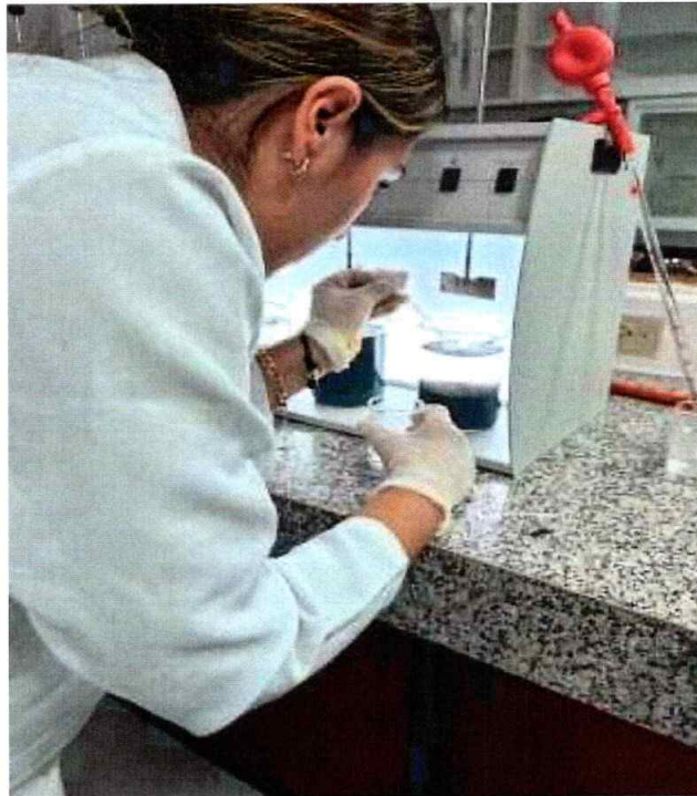
Figura 23 Se recolectó agua clarificada para la medición del pH.
