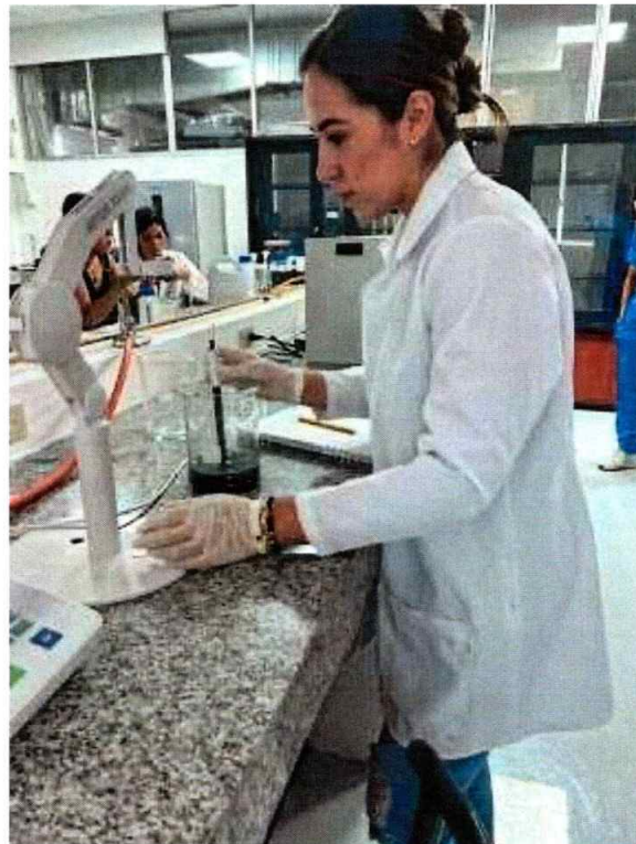
Figura 16 Medición de pH con la muestra cruda.
