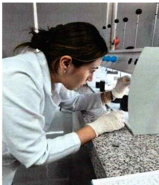
Figura 22 Se añadió reactivos para iniciar el proceso de coagulación y sedimentación
