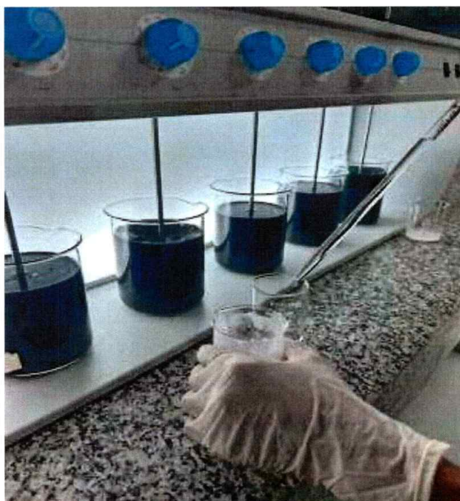
Figura 6 Se añade reactivos a la muestra cruda.
