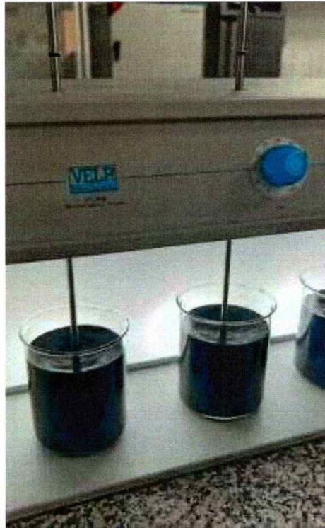
Figura 5 Tratabilidad de las aguas residuales en el floculador.
