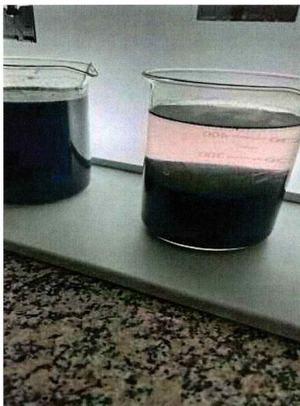
Figura 9 Proceso de Sedimentación del agua tratada
