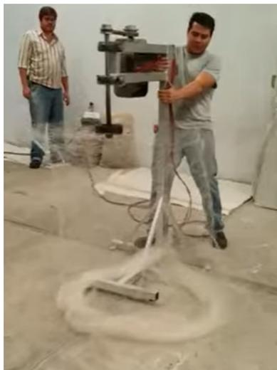
**Nota:** En la Figura se observa la operación de un equipo utilizado para la elaboración de hilos de polímeros de forma continua, de manera que los mismos puedan ser enrollados en roletes para su almacenamiento y transporte para su posterior uso en diferentes productos (Cardoso, 2015).
