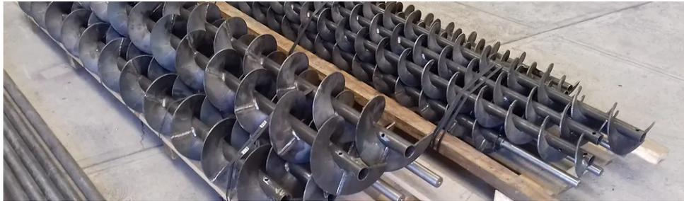
**Nota:** Se preseta el tornillo helicoidal a considerara pra el diseño de la maquina procesadora de fibras. (Bega Helicoidales, 2023).
