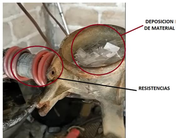
**Nota:** Se puede observar que en el deposito, previamente el material debe ser triturado o convertido a microplasticos para el mejor movimiento del molino hacia la resistencia que lo transforma en resina. Contreras (2021).
