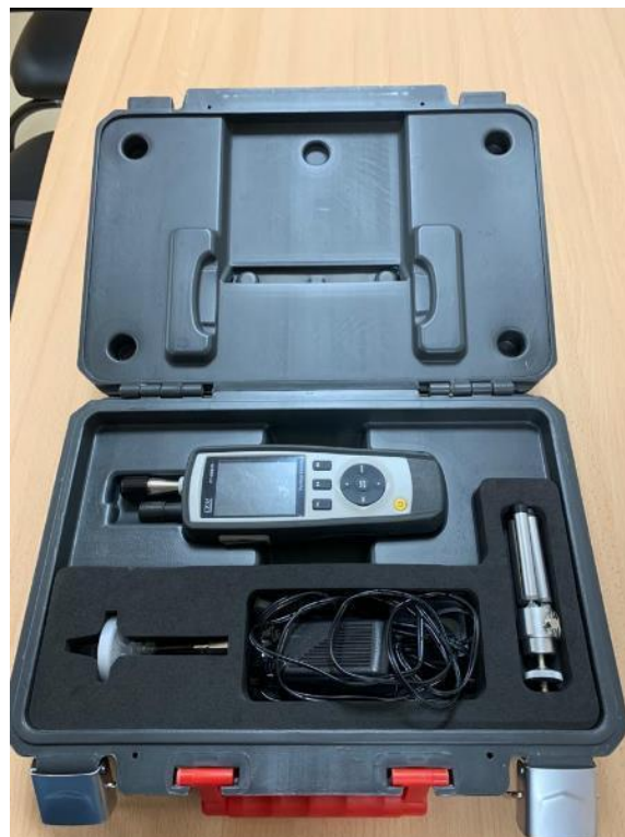
Figura No. 29 Equipo utilizado para la medición de material particulado
