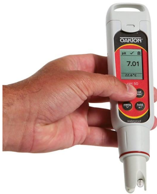
Figura No. 32 Equipo utilizado para la medición de parámetros de agua residual in situ
