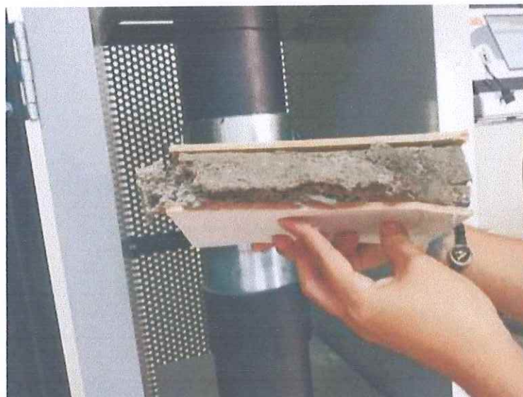
Figura 4. Compresión de adoquines a partir de lodos residuales Muñoz, 2023
