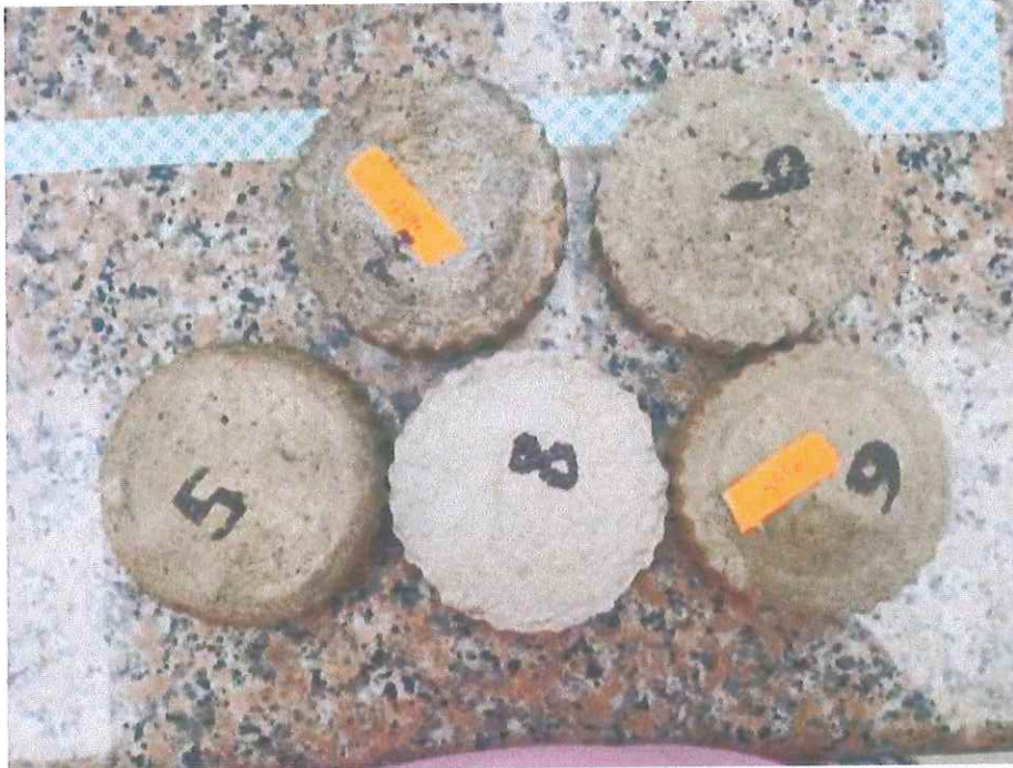
Figura 11. Pruebas de adoquines a partir de lodos residuales Muñoz, 2023
