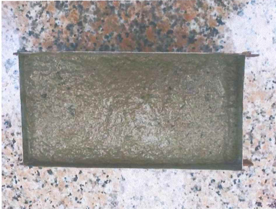
Figura 9. Moldeado de adoquines a partir de lodos residuales Muñoz, 2023
