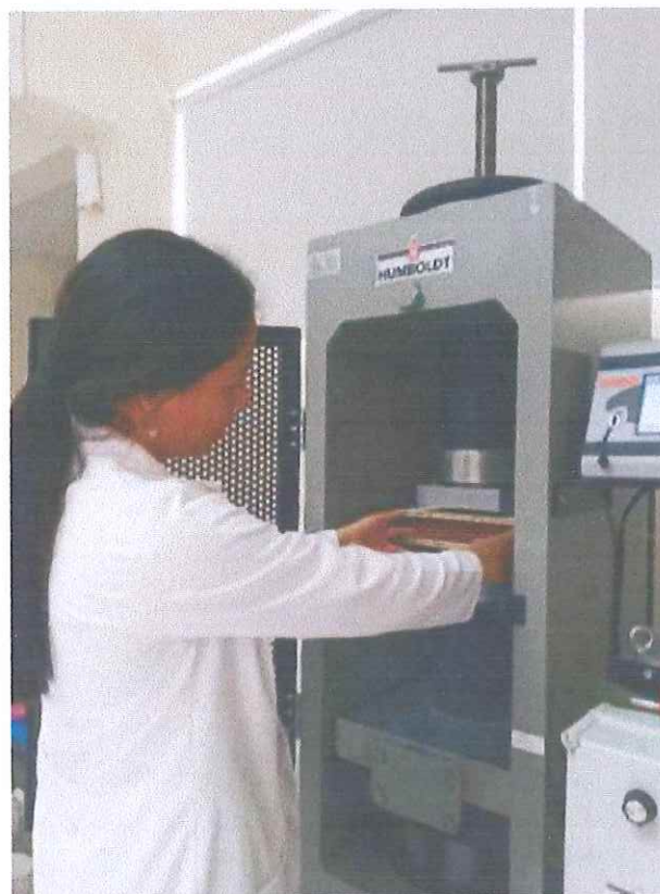
Figura 8. Control de calidad de adoquines a partir de lodos residuales Muñoz, 2023
