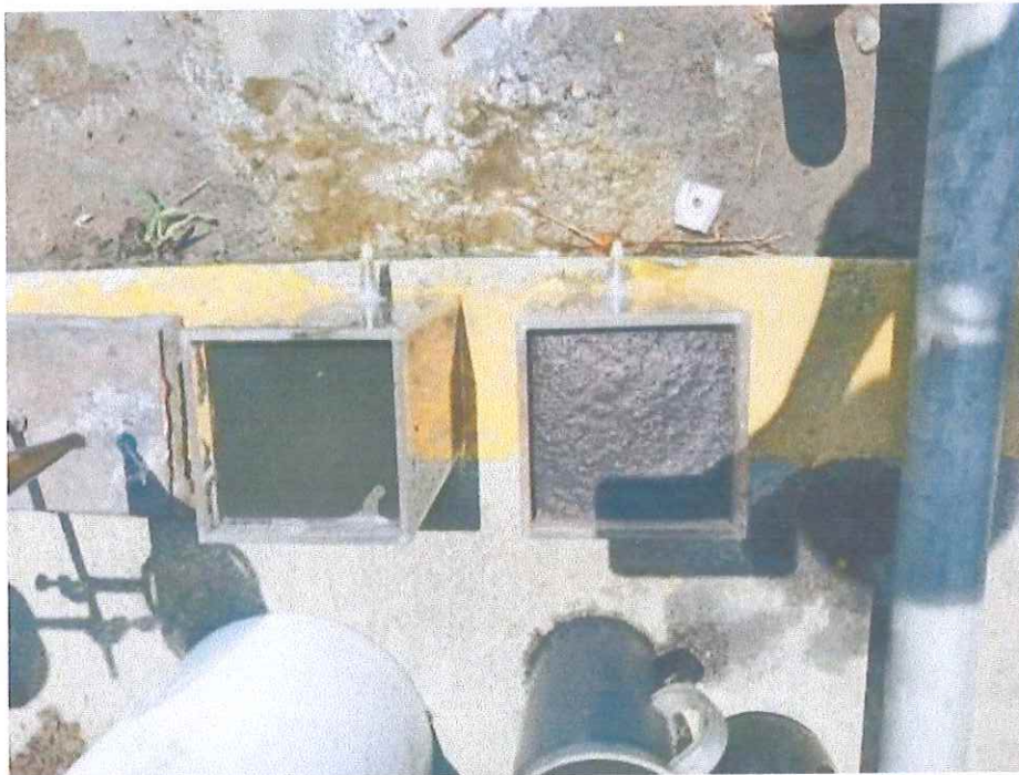
Figura 12. Mezclas de adoquines a partir de lodos residuales Muñoz, 2023
