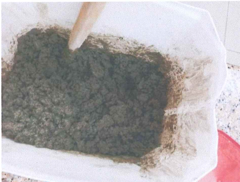
Figura 10. Mezclado de adoquines a partir de lodos residuales Muñoz, 2023
