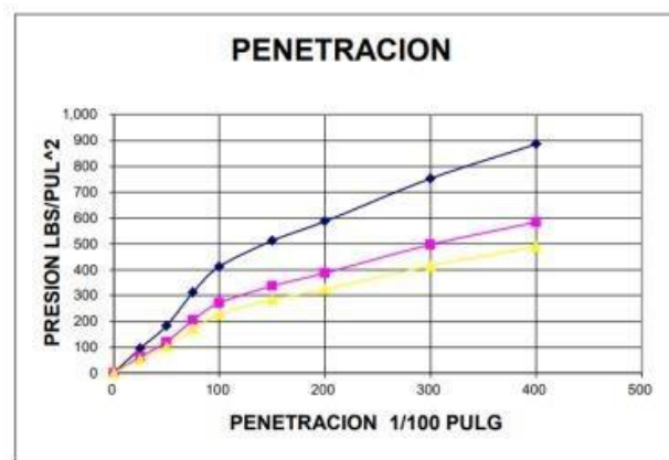
Ilustración 9: RELACIÓN ENTRE PENETRACIÓN DEL SUELO Y CARGA UNITARIA O CAPACIDAD DE SOPORTE
