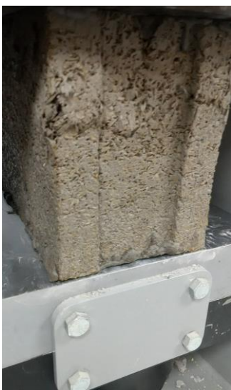
Muestra 3: Obtención de resultados del ensayo a compresión.
