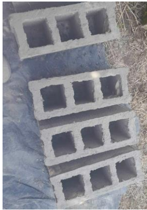
Imagen 9: Bloques recubiertos con mortero.
