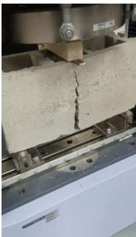
Imagen 16: Observación de la tracción y flexión del bloque.
