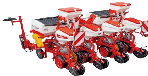
Figura 7. Sembrador a mono grano. [19]
