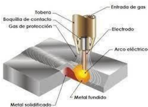
Figura 18. Soldadura Eléctrica (MIG). [40]
