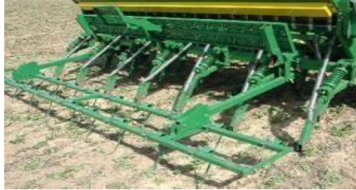
Figura 8. Sembrador a chorrillo. [21]
