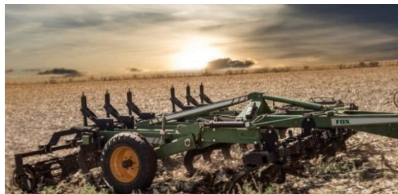
Figura 4. Arado de escarificador. [12]
