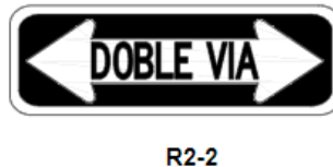
Figura 6. Señalización Doble vía (R2-2)
