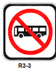
Figura 10. Señalización No buses (R3-3)
