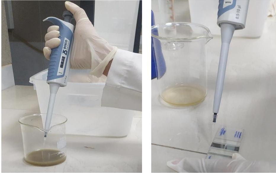
**Nota:** sobre la cámara de Neubauer se depositaron 10  $\mu$ l, dicho volumen se desplaza hacia la cámara debido a la capilaridad que posee.
