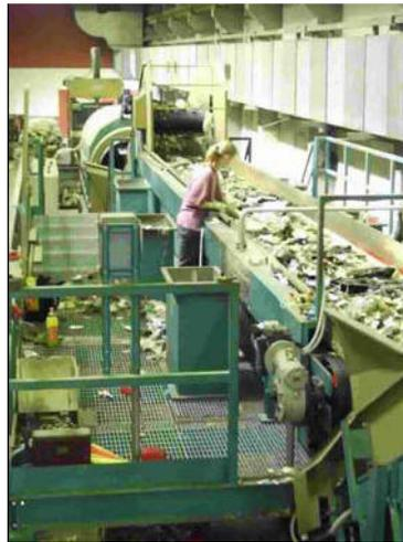
**Ilustración 7 CINTA DE TRANSPORTACIÓN PARA CLASIFICACIÓN Y SEPARACIÓN<sup>51</sup>**
