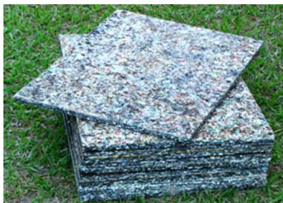
**Ilustración 46 PLANCHA DE MADERA PLASTICA RECICLADA (EXTRUIDA)<sup>138</sup>**
