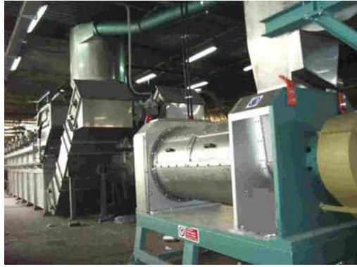
**Ilustración 11 LÍNEA DE LAVADO SECADO CENTRIFUGADO<sup>55</sup>**
