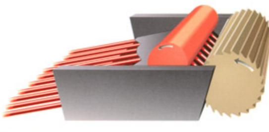
**Ilustración 36 PELETIZADORA<sup>86</sup>**
