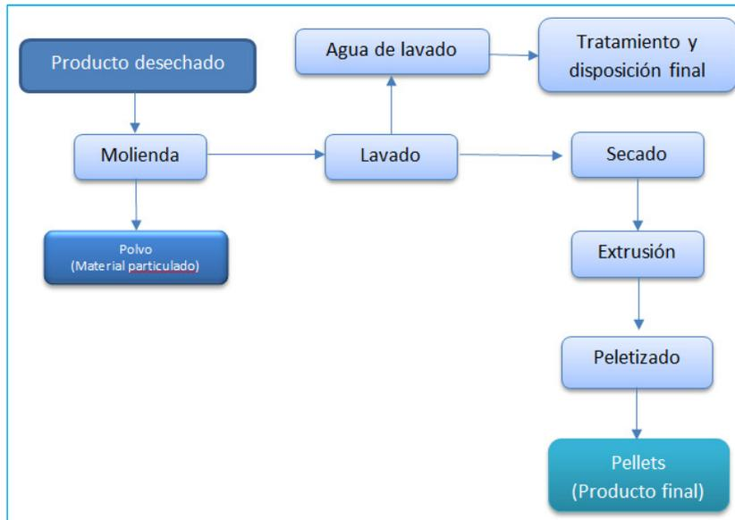
Esquema 17 Procesos de Extrusión<sup>58</sup>
