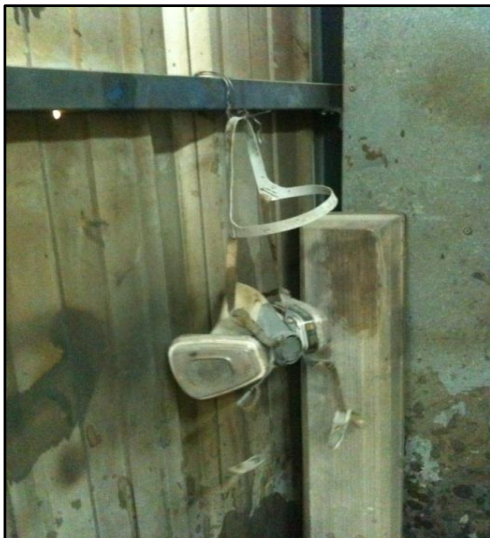
Equipo de protección personal mal almacenado
