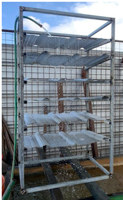
Figura 33 Colocación del relleno en el sistema de enfriamiento
