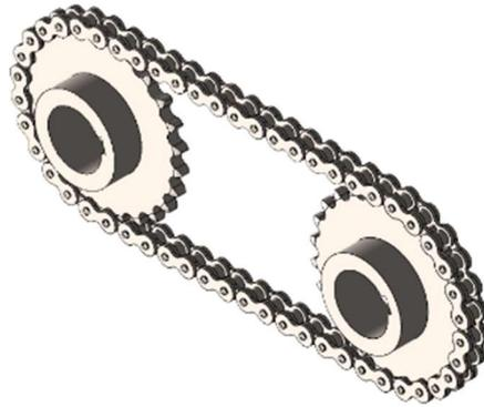
*Figura 12. Transmisión mediante cadenas [20]*
