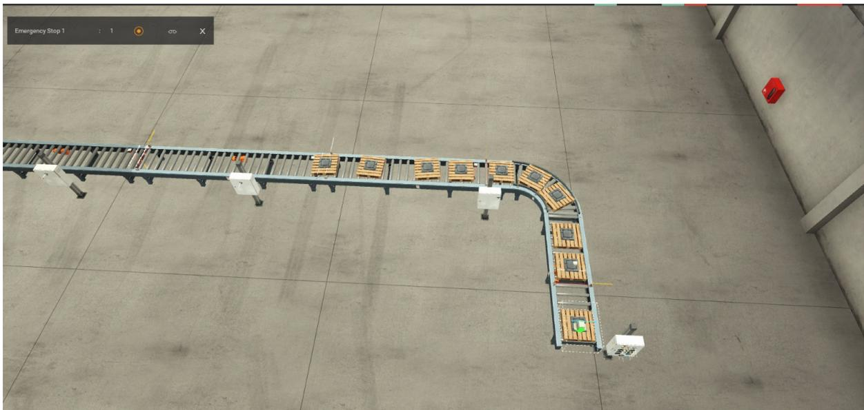
Sin embargo, podemos observar en la figura 15 como se logró crear un movimiento controlado de los palets y que se puedan distribuir en la línea adecuadamente, donde no se generó un cuello de botella excesivo durante el cambio de una línea a otra.
