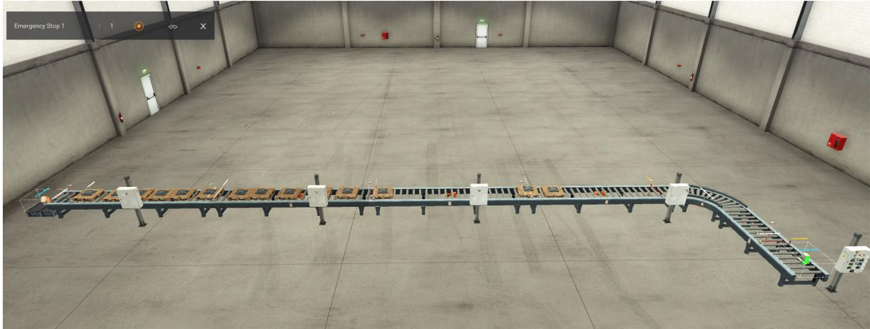
Para tener una simulación lo más parecida a la realidad se configuró un emisor y un removedor al inicio y final de la línea, respectivamente, para poder crear y retirar los palets que se van transportando a lo largo de la banda como se indica en las figuras 12 y 13.
