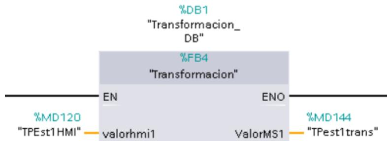
En el parámetro “Valor HMI” se debe ingresar un dato de tipo DInt, este dato se solicita en segundos y se guarda, ya transformado en milisegundos, en una variable tipo DInt que se conecta a la salida “ValorMS1”. Este bloque en específico lo usamos para los valores de tiempos, de paro y activación, en las estaciones 1 y 2, también lo utilizamos para los tiempos de pausa que se podrán configurar.
