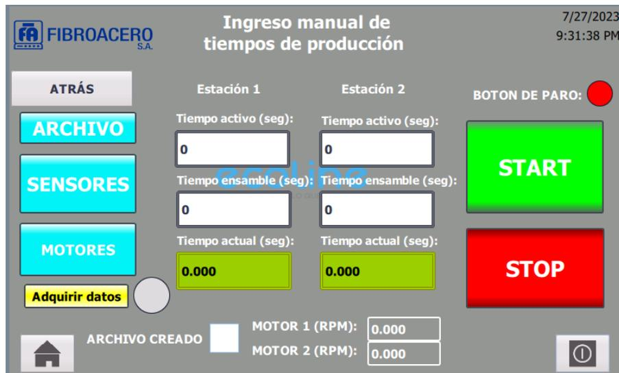
Una vez configurados todos los parámetros necesarios, de tiempos y motores, se puede dar en “START” para que la línea empiece a trabajar.
