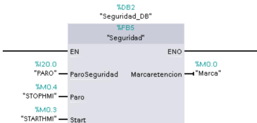
Para poder utilizar el Bloque de función seguridad (figura 3) se debe conectar un pulsante normalmente cerrado (NC) al parámetro denominado "ParoSeguridad", para el resto de
