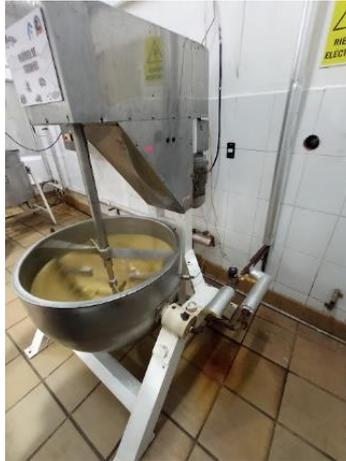
**Figura 8.** Mezcla de elementos principales en la marmita
