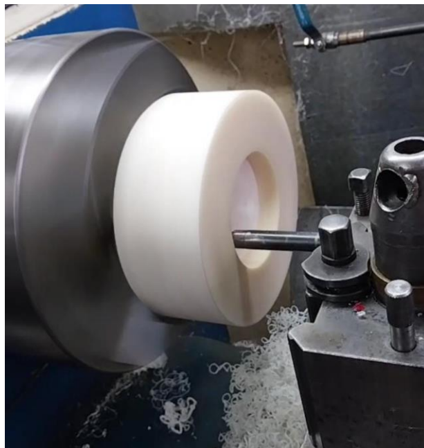
Figura 49: Mecanizado de la base
