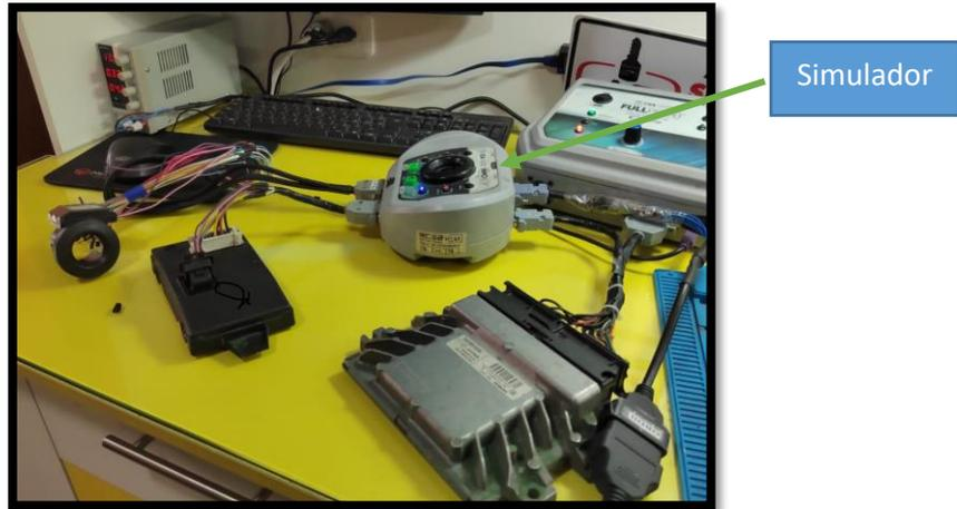
**Figura 50.** Pruebas de conexión con ayuda de un bando simulador de módulos
