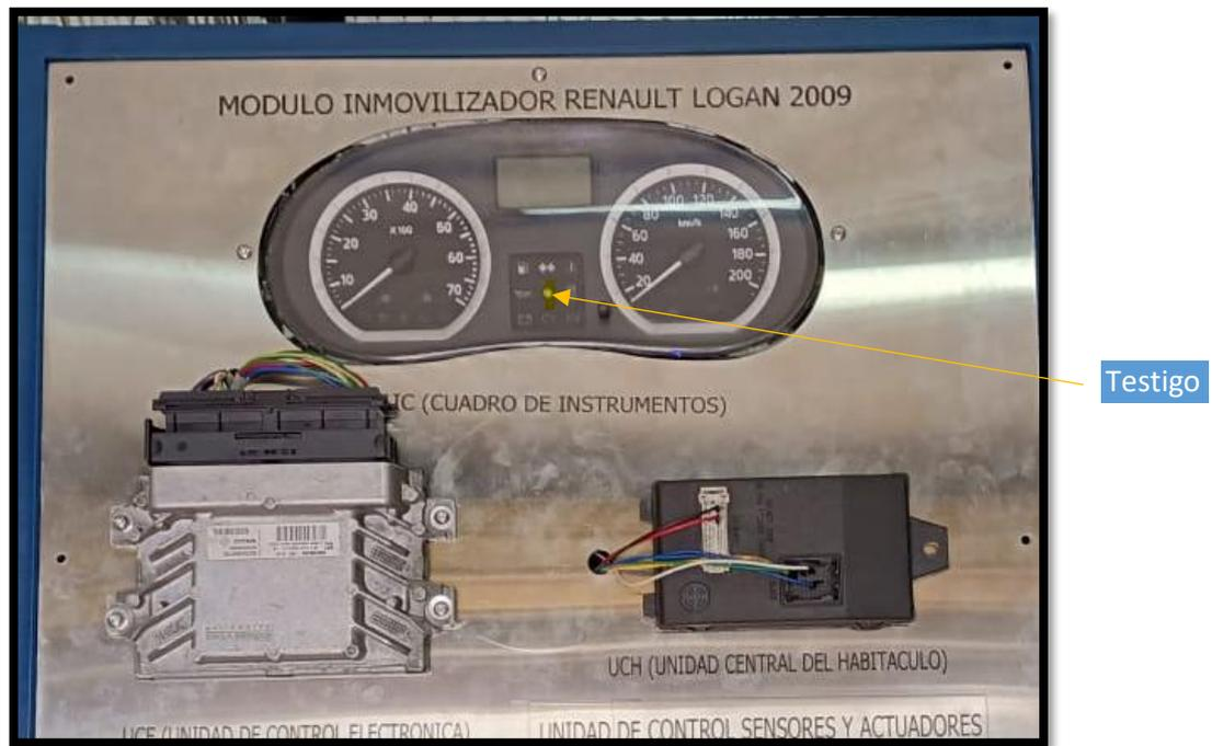
**Figura 56.** Testigo sistema antiarranque activado
