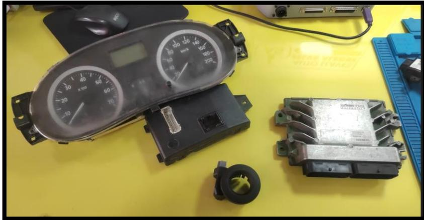
**Figura 3.** Elementos sistema inmovilizador
