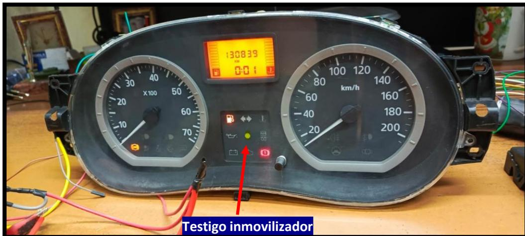
**Figura 53.** Ubicación del testigo del sistema inmovilizador
