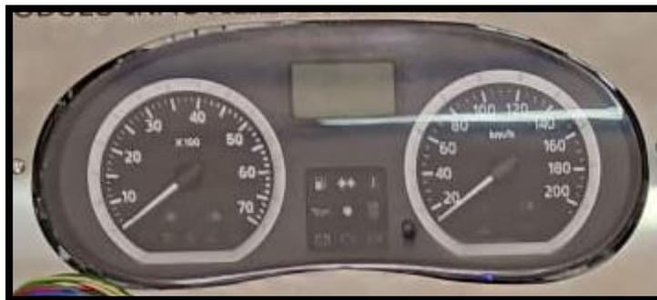
**Figura 58.** Cuadro de instrumentos en blanco, socket desconectado
