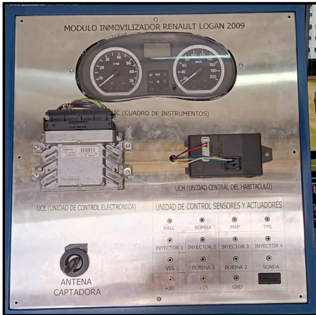
*Figura 49.* Montaje de los componentes en el banco de pruebas inmovilizador
