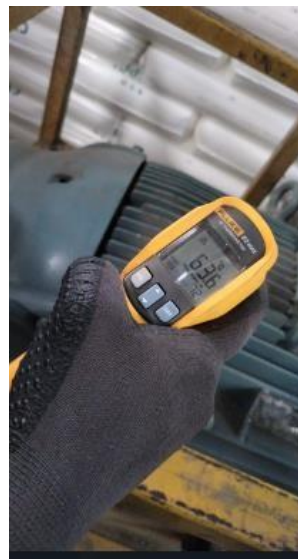
FIGURA 11 MEDICIÓN DE TEMPERATURA EN EL MOTOR PRINCIPAL
