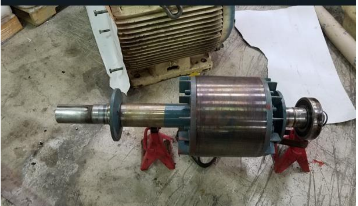
ANEXO 3 MANTENIMIENTO AL MOTOR PRINCIPAL
