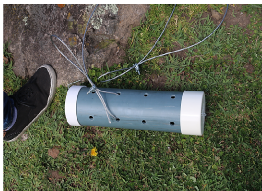
Figura 3. Muestreadores pasivos colocados en los cuerpos de agua.
