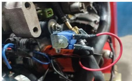
**Fig. 12.** Válvula interruptora para el paso de combustible
