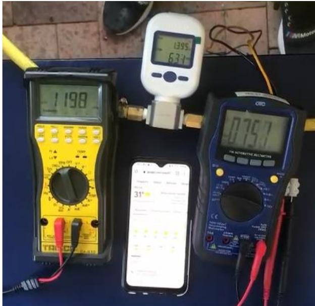
Fig.33. Valores de rpm, voltaje TPS y Flujo SLPM durante la Prueba con H2
