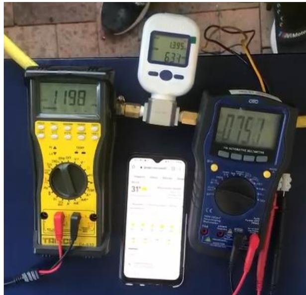
**Fig. 41.** Valores de rpm, voltaje TPS y flujo SLPM durante la prueba con H2
