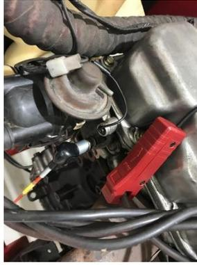
**Fig. 14.** Pinza para medir RPM del multímetro TRISCO
