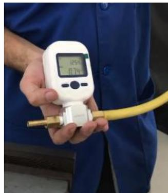
**Fig. 66.** Apertura uno donde el hidrógeno medido es 0,74
