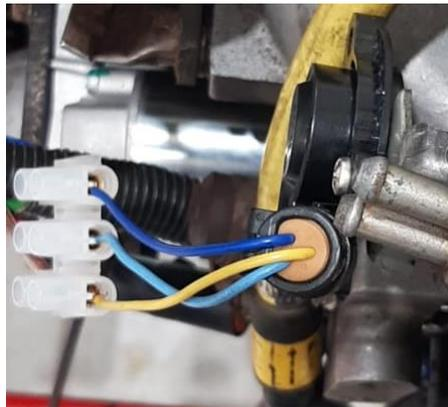
**Fig. 9.** Cableado sensor TPS
