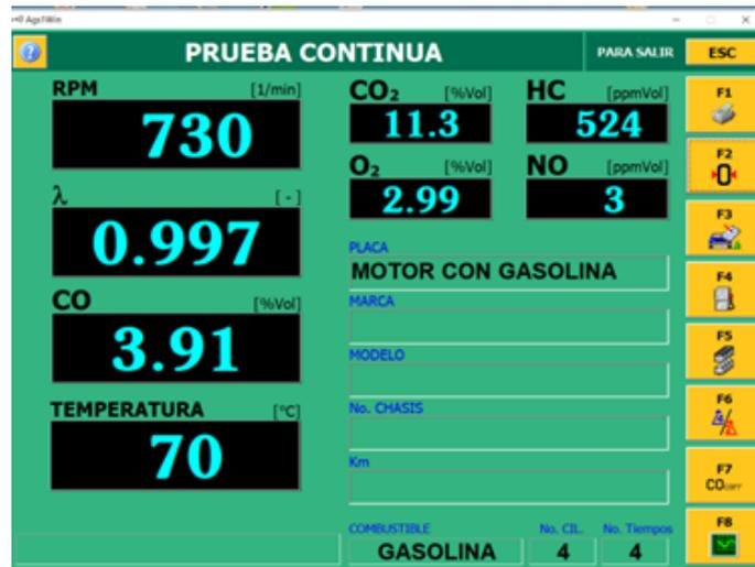
**Fig. 17.** Toma de datos análisis de gases(CO 3.91)
