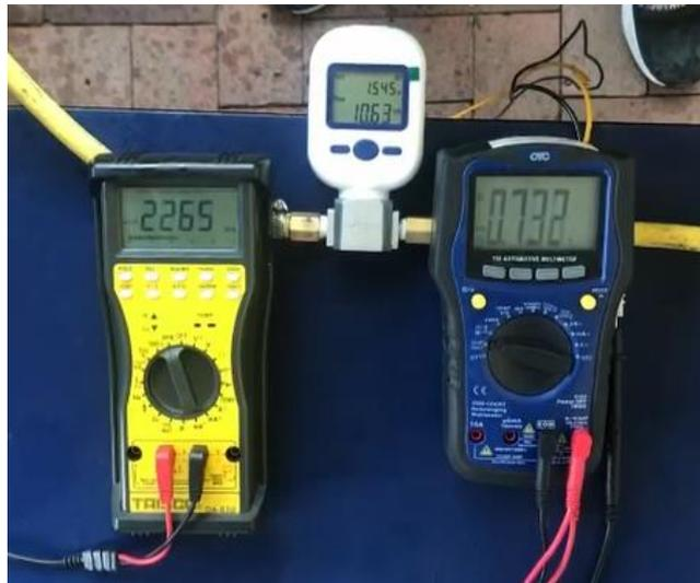
Fig. 34. Valores de rpm, voltaje TPS y Flujo SLPM durante la Prueba con H2
