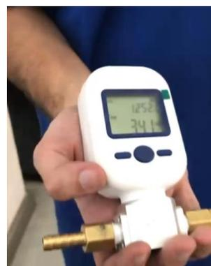
**Fig. 68.** Apertura tres donde el hidrógeno medido es 3,41
