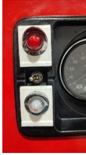
**Fig. 11.** Interruptor bomba eléctrica combustible
