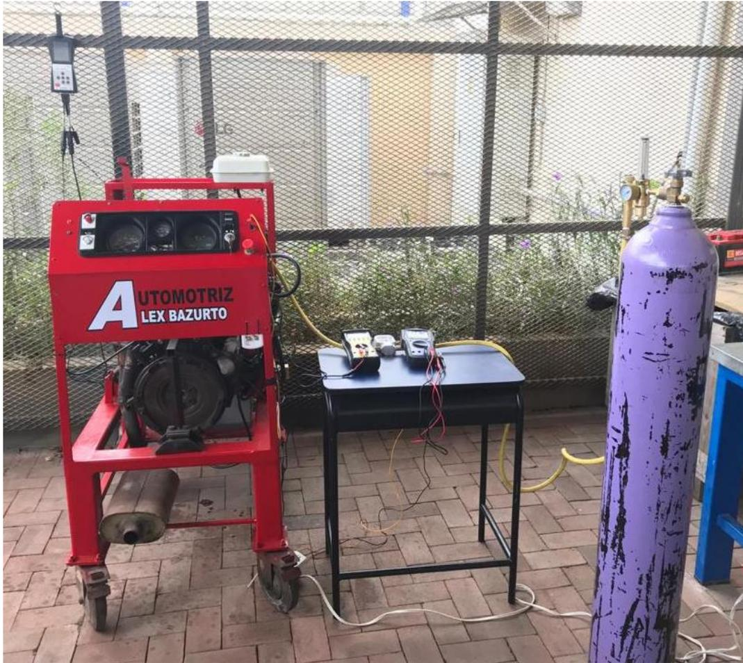
**Fig. 23.** Configuración para prueba experimental con Tanque de Hidrógeno de 6m<sup>3</sup>
