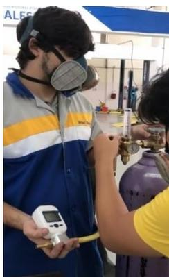
**Fig. 32.** Prueba del medidor de flujo (Hidrógeno)
