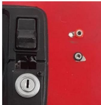
**Fig.7.** Extensión de la señal de voltaje del sensor TPS en el panel frontal
