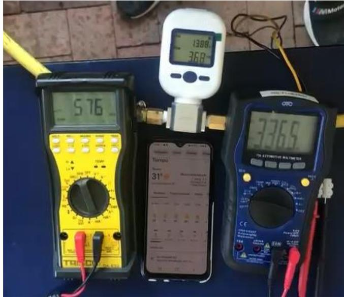
**Fig. 40.** Valor de rpm, voltaje TPS y flujo SLPM durante la prueba con H2
