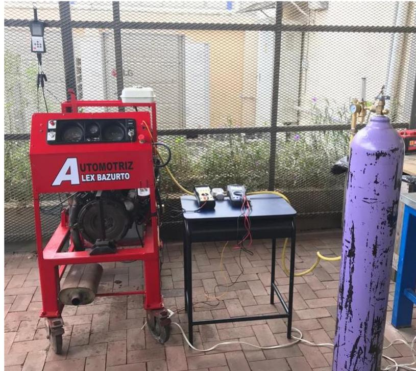
Fig. 4. Configuración para prueba experimental con Tanque de Hidrógeno de 6m3
