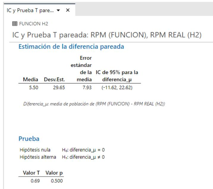
Fig.45.Resultado Minitab T pareada (comprobación de la función)
