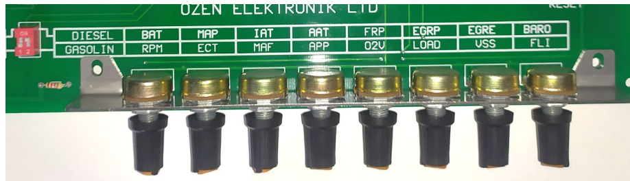
Figura 1.3: Modos DIESEL/GASOLINA de la tarjeta mobydic 4910.
