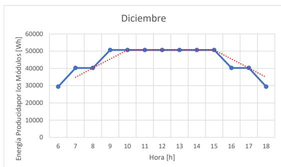
Figura 13 Energía producida por los módulos a diario por el mes de diciembre
