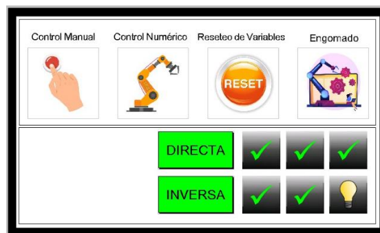
Figura 85. Ventana principal del HMI.
