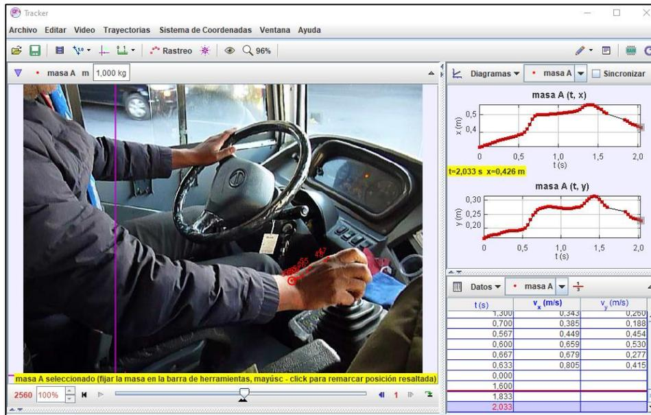
Figura 30. Evaluación de la postura de cambio de marcha mediante Tracker
