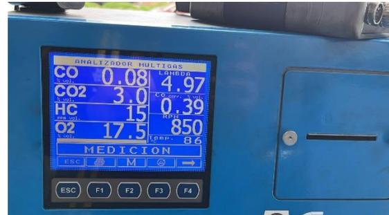
Figura 15: Prueba 2 datos en condición ralentí a temperatura de motor 87.36 °C
