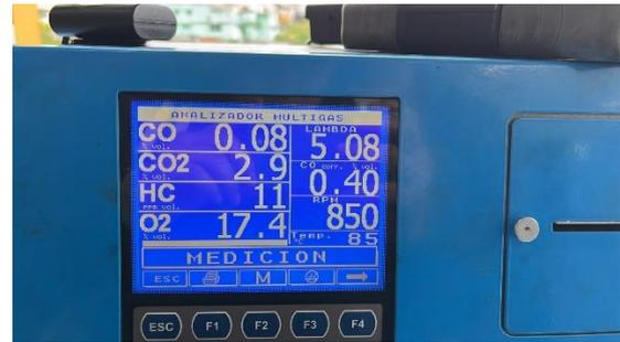
Figura 14: Prueba 1 datos en condición ralentí a temperatura de motor 87°C
