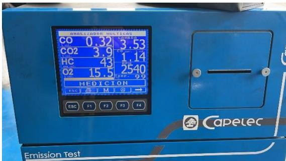
Figura 12: Prueba 1 datos en condición 2500 rpm a temperatura de motor 93,206 °C
