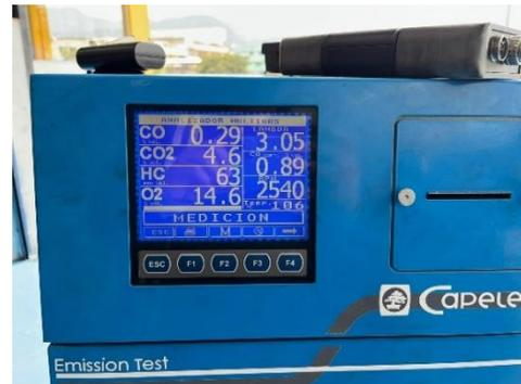
Figura 16: Prueba 1 datos en condición 2500 rpm a temperatura de motor 89,96 °C
