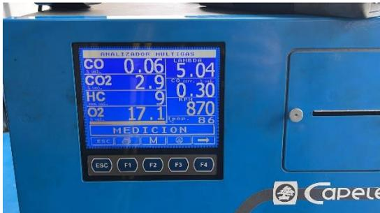
Figura 11: Prueba 2 datos en condición ralentí a temperatura de motor 87,36 °C
