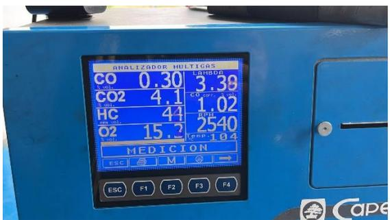
Figura 13: Prueba 2 datos en condición 2500 rpm a temperatura de motor 91 °C
