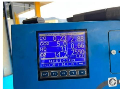
Figura 17: Prueba 2 datos en condición 2500 rpm a temperatura de motor 89 °C
