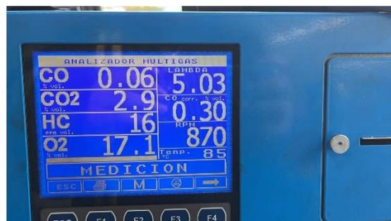
Figura 10: Prueba 1 datos en condición ralenti a temperatura de motor 87,36 °C
