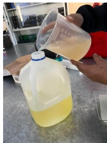
Figura 9: Mezcla de biodiésel 15% y diésel comercial 85%
