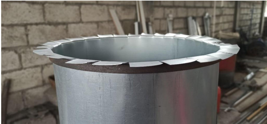
Figura 2.16 Salida del difusor cónico
