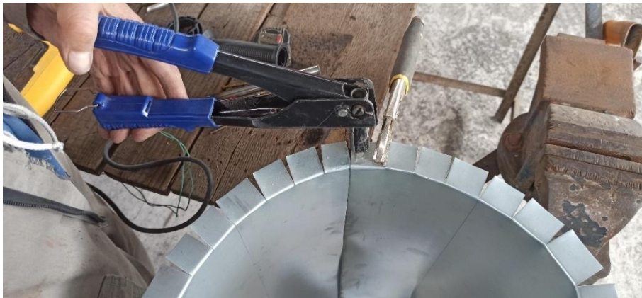
Figura 2.17 Zona del difusor cónico con remaches
