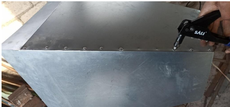
Figura 2.11 Zona de contracción remachada
