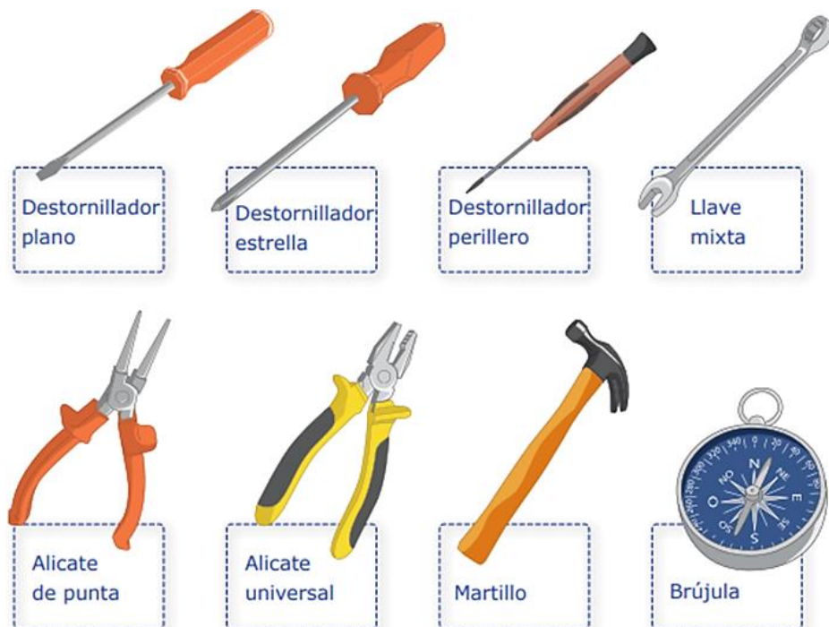
Figura 49 Herramientas Básicas (Manual de Instalación)
