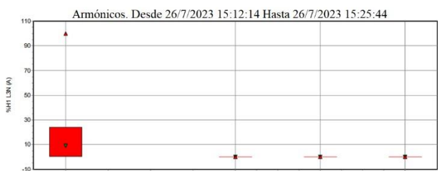
Fig. 9. Distorsión armónica de corriente en la línea 3
