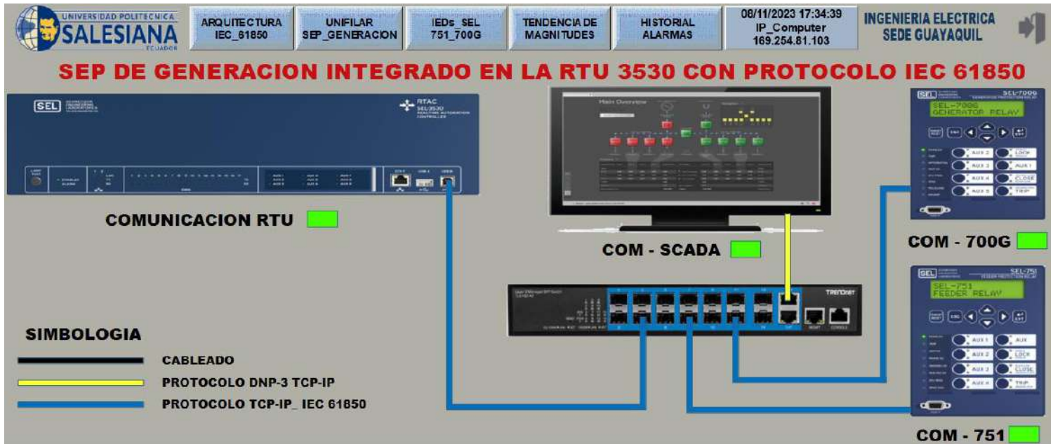
Anexo 2: Prueba de comunicación activa de los equipos.
