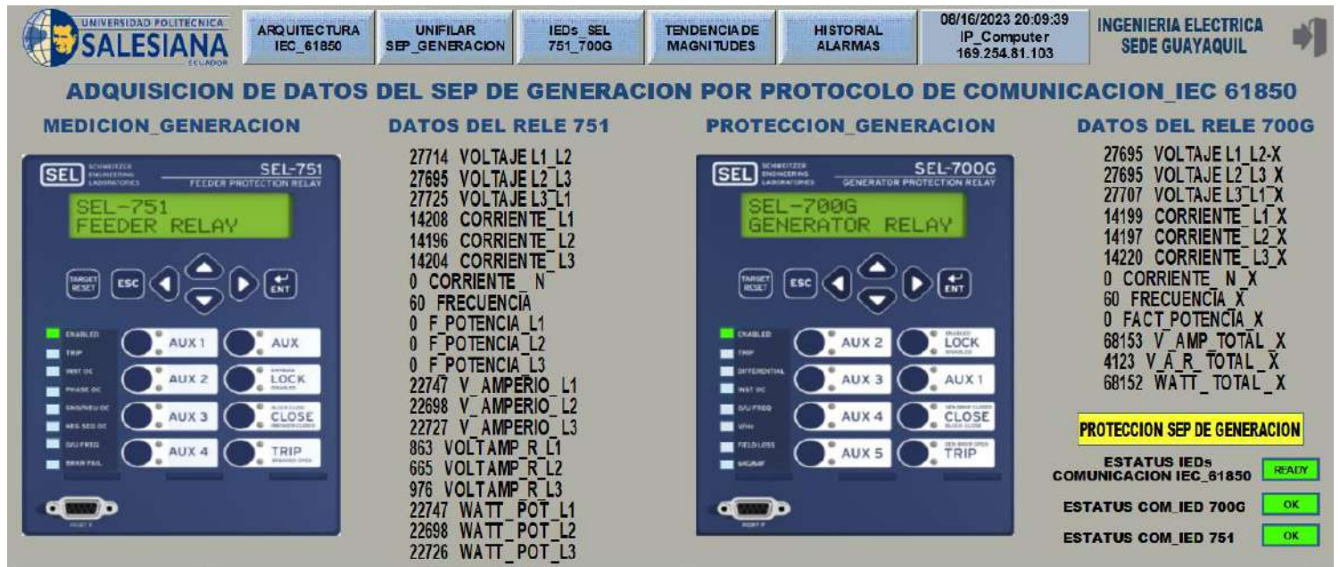
Anexo 13: Prueba de inyección con 108 V, función 50/27.
