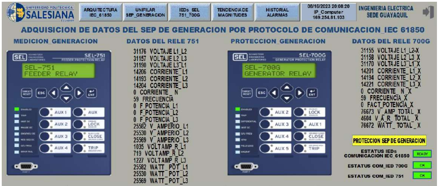
Anexo 11: Prueba de inyección zona # 1 con 108 V, función 27.
