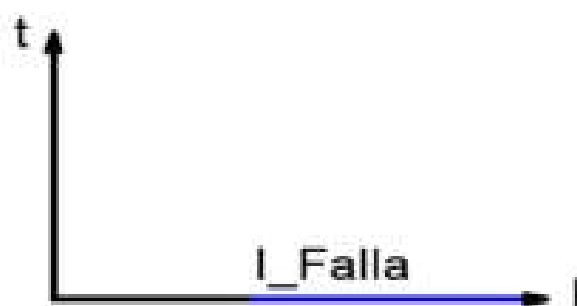
Figura 16: Gráfica de la protección 50 Sobrecorriente instantánea. [16]
