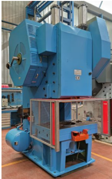
Figura 3. Prensa mecánica Delteco PE-160 [9].
