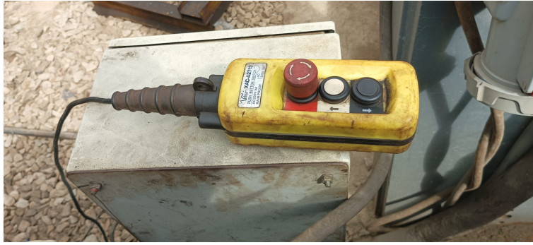
Figura 101. Botonera para el envío de señales a la electroválvula, por M. Aguilar y E. Pincay
