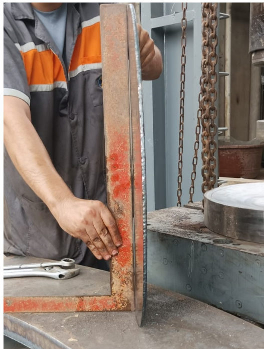
Figura 65. Tapa en plancha de 6mm de espesor x 600 mm de diámetro sin bombear, por M. Aguilar y E. Pincay
