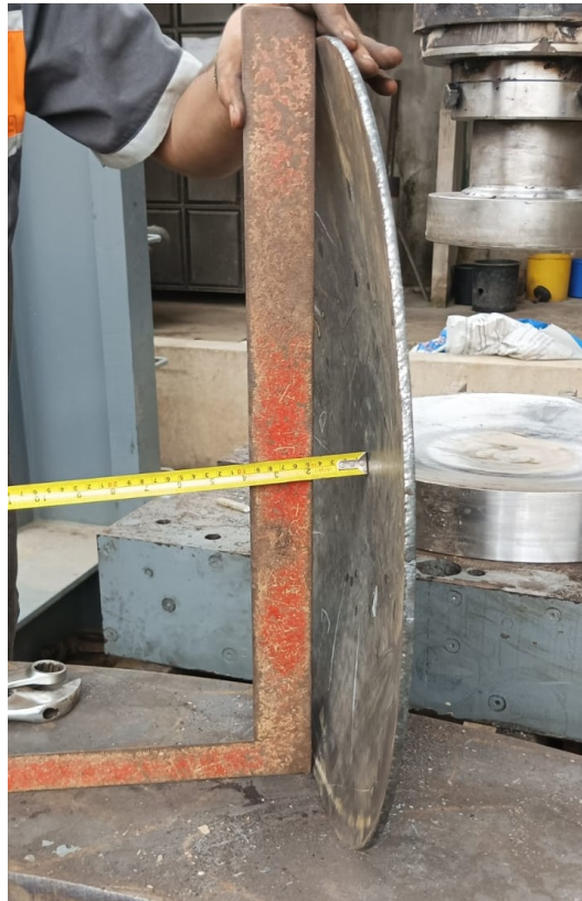
Figura 66. Tapa en plancha de 6mm x 600 mm bombeada, por M. Aguilar y E. Pincay
