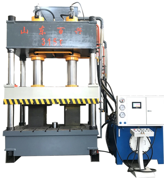
Figura 4. Prensa de conformado de 315 toneladas [21].
