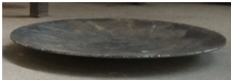
Figura 67. Tapa toriesféricas terminada en plancha de 6mm x 600 mm bombeada, por M. Aguilar y E. Pincay
