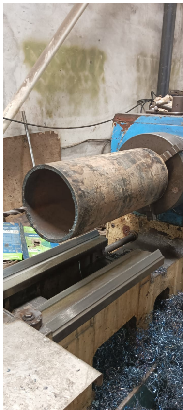
Figura 102. Torneado de tubo para extensión del punzón, por M. Aguilar y E. Pincay
