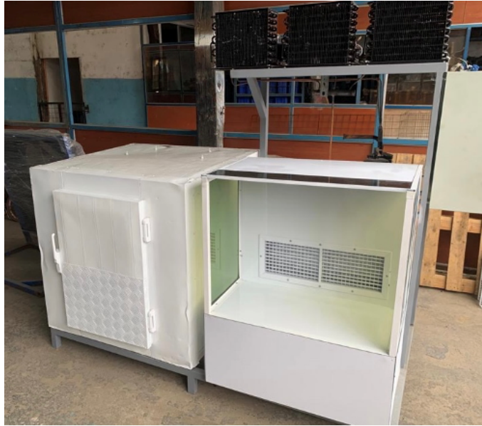
Figura 1. Prototipo de un un sistema automático de refrigeración industrial con un circuito de compresores en paralelo.
