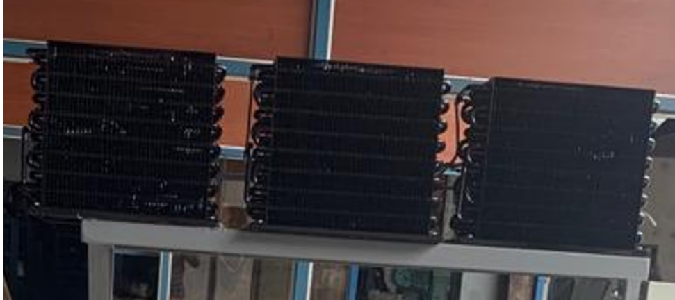
Figura 19. Condensadores, vista de frontal.
