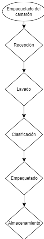
Figura 5. Diagrama de flujo de etapas del proceso de empaquetado del camarón.
