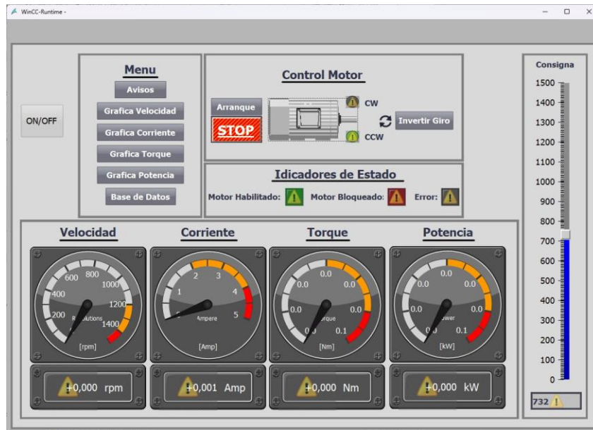
Figura 3.54: Prueba de funcionamiento HMI Imagen_raíz con errores.
