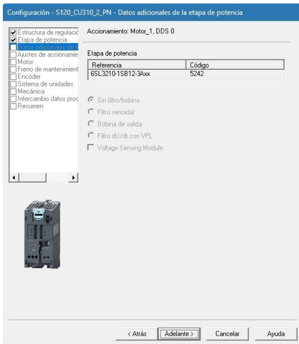
Figura 1.18: Datos adicionales de la etapa de potencia (STARTER).
