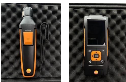
Figura 2. (a) Sonda de CO modelo 0632 1271 (b) Medidor de climatización Modelo 0560 4401.
