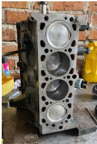
*Anexo 11. Montaje de los pistones en el bloque motor.*
