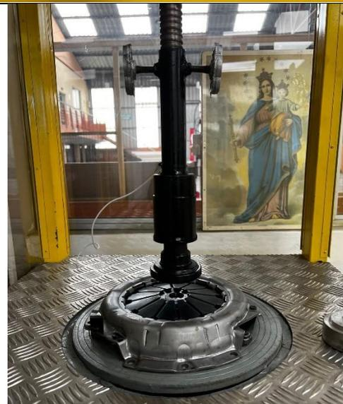
11. Introducir la galga de calibración entre el rodillo de empuje y el diafragma para asegurar que el recorrido sea el mismo en todos los platos de presión y finalmente se asegura el vástago mediante los bloqueos que se encuentran a los extremos del vástago.
