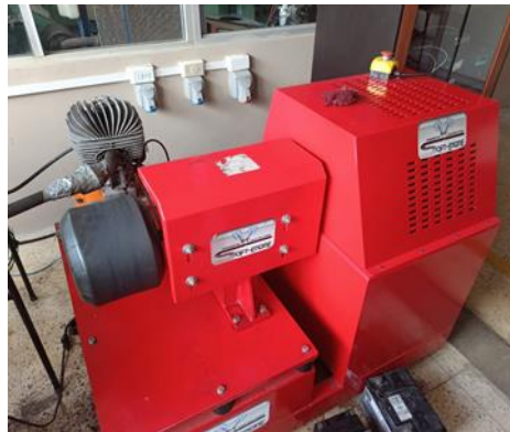
Ilustración 1. 18. Banco Dinamométrico Soft-Engine Motor Braker 120
