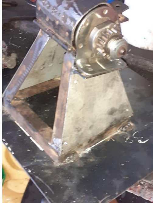
Ilustración 3. 5. Estructura de apoyo construida
