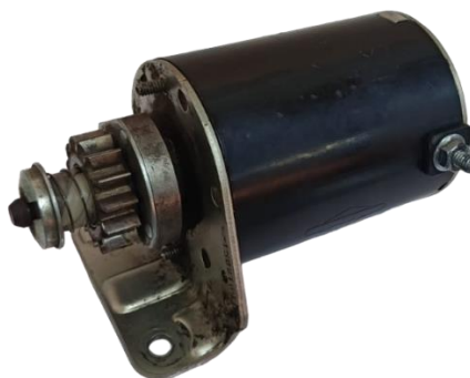
Ilustración 2. 28. Motor de Arranque Podadora John Deere E110
