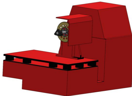
Ilustración 2. 18. Modelo 3D Banco Dinamométrico Soft- Engine Motor Braker 120
