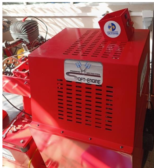
Ilustración 3. 39. Caja de mando implementada en el Banco Dinamométrico
