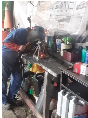
Ilustración 3. 4. Soldado de la estructura de apoyo
