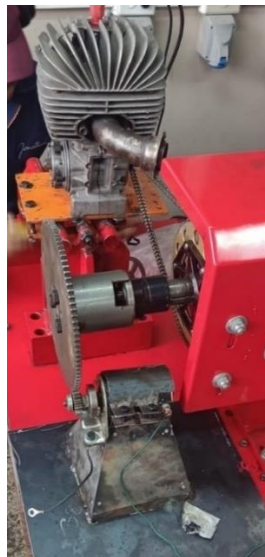
Ilustración 3. 7. Instalación del Motor de arranque con su Estructura de apoyo en el Banco Dinamométrico
