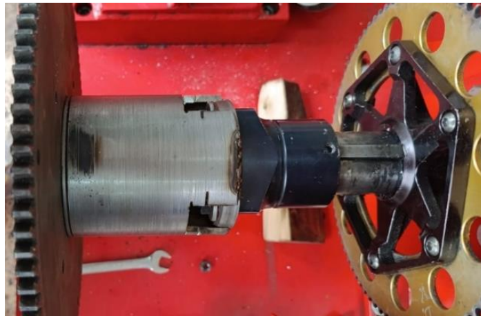
Ilustración 3. 2. Instalación del acople expansor con el volante en el eje
