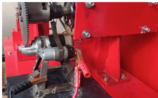
Ilustración 3. 12. Instalación del nuevo Motor de Arranque con su estructura de apoyo
