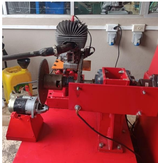
Ilustración 3. 13. Cambio de sentido del sistema de arranque
