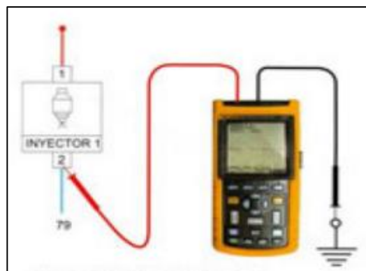
Figura 4. Conexión del osciloscopio al inyector
