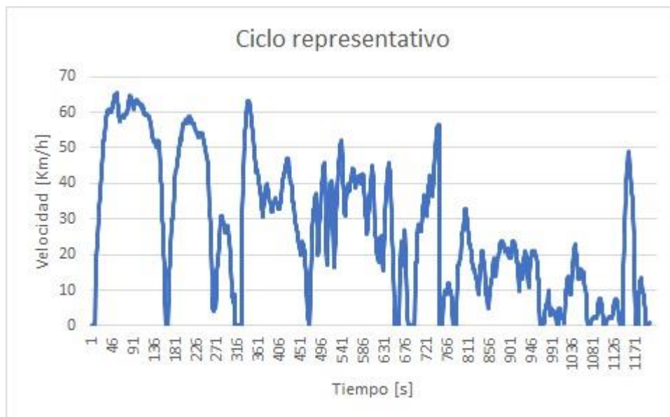
Figura 9 Gráfica del ciclo de conducción mediante Micro-Trips de un viaje dentro del Cantón Rumiñahui.
