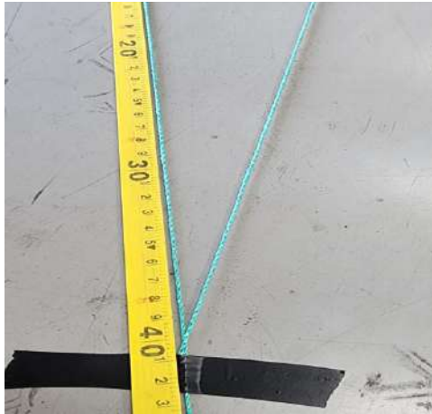
Figura 47: Distancia de la rueda delantera al centro.
