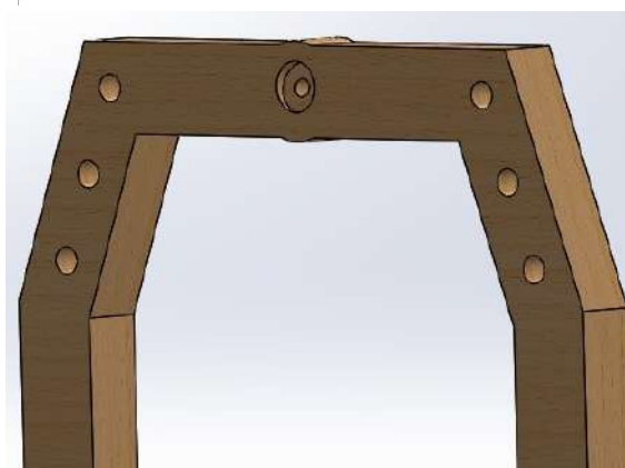
Figura 2: Mesa anterior del prototipo fabricada con grilón.
