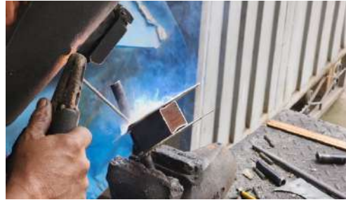
Figura 20: Soldadura de ambas placas al tubo.
