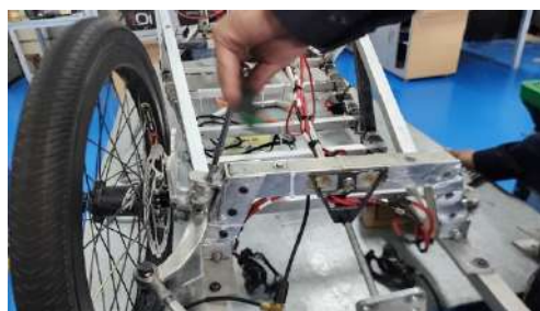
Figura 27: Perno de la mangueta derecha antigua.
