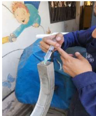
Figura 14: Vertimiento de resina en el tubo cuadrado.
