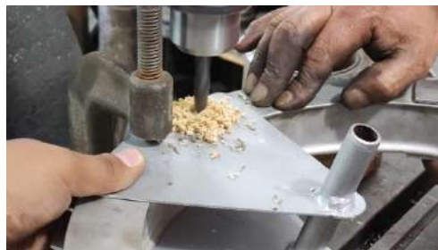
Figura 19: Perforación de la base de la columna de dirección.
