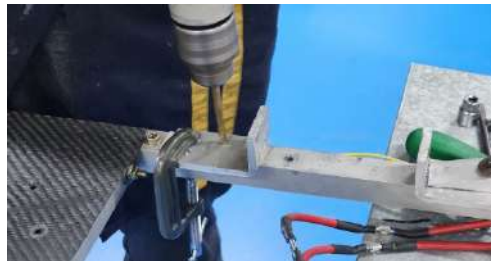
Figura 30: Nuevas perforaciones al chasis.
