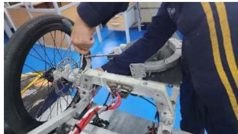
Figura 26: Perno de la mangueta izquierda antigua.
