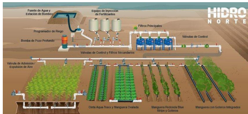
Riego por goteo, modelo a gran escala.
