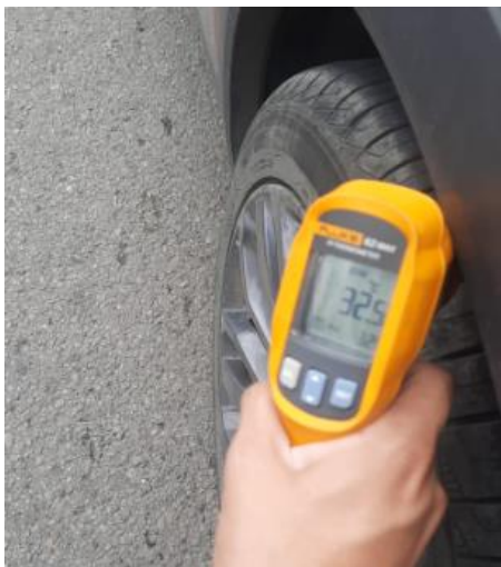
Figura 18 Prueba de temperatura con pirómetro.
