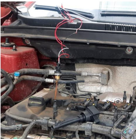
Figura 14 Acople instalado en el vehículo
