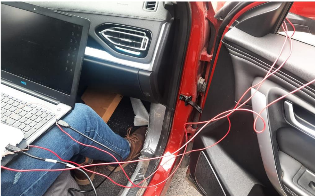
Figura 20 extensión de los cables de pines del sensor para prueba en ruta.
