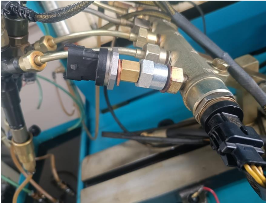
Figura 10 Sensor acoplado en el banco CRDI
