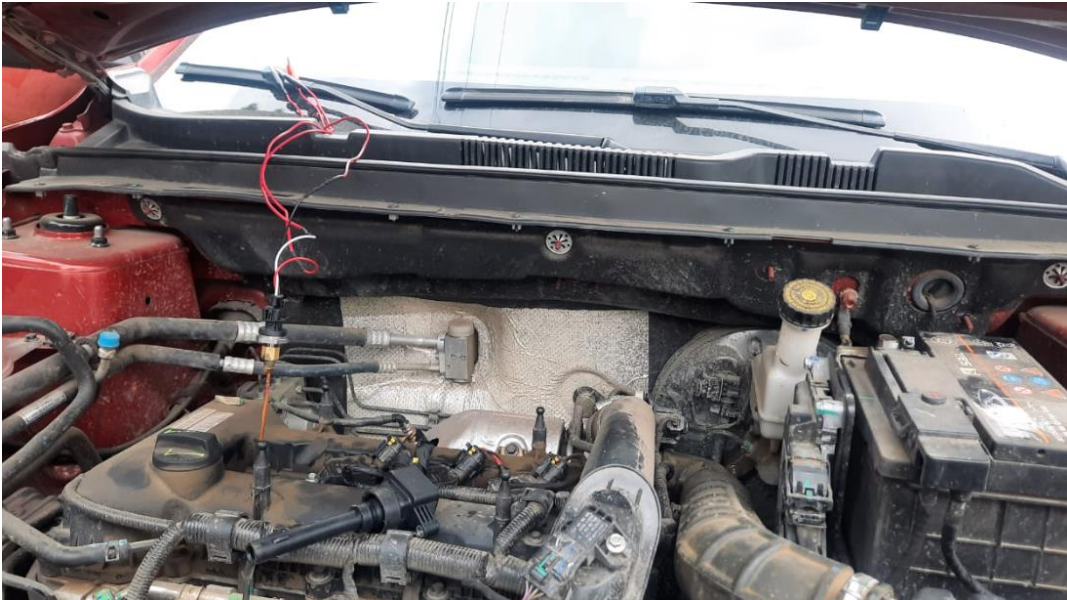
Figura 19 acople con una extensión en los cables de los pines, para prueba en carretera
