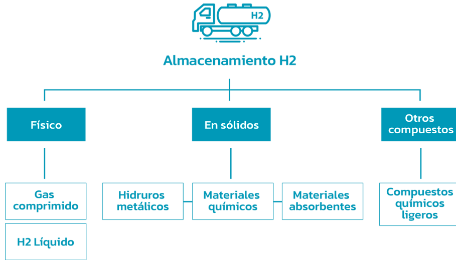
Figura 1.6. Almacenamiento del hidrógeno.
