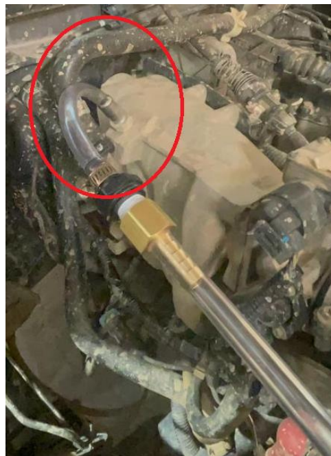
Figura 3.1. Hidrógeno conectado a cañería de vacío.
