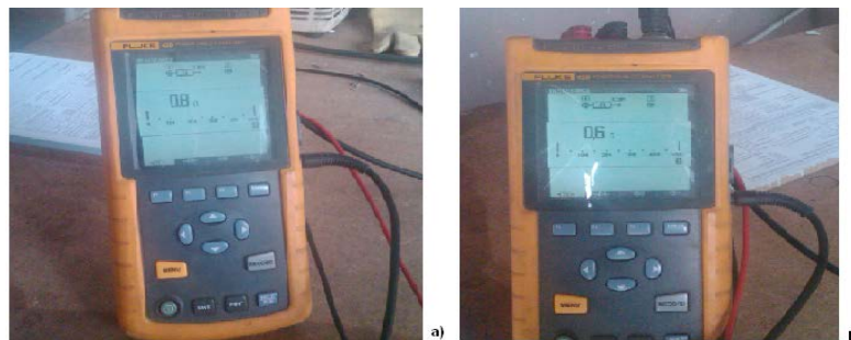
FIGURA 6.9 TOMA DE MEDIDA DE RESISTENCIA EN LOS DEVANADOS DESPUÉS DE LA PRUEBA, (A) RESISTENCIA EN ALTA TENSIÓN, (B) RESISTENCIA EN BAJA TENSIÓN.
