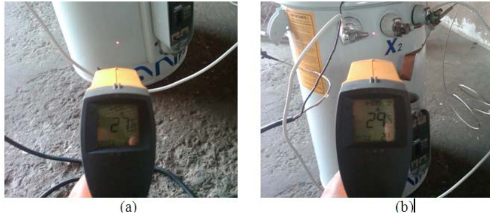
FIGURA 6.10 TOMA DE TEMPERATURA, (A) PARTE INFERIOR DEL TANQUE, (B) PARTE SUPERIOR DEL TANQUE
