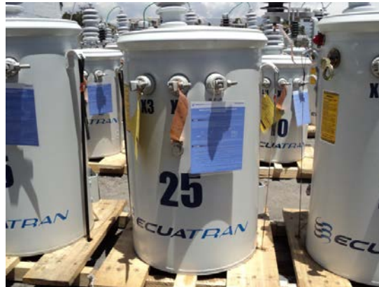
FIGURA 1.1 TRANSFORMADOR DE DISTRIBUCIÓN
