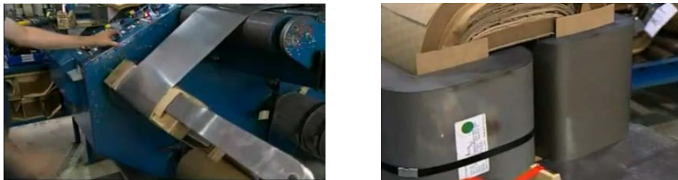
FIGURA 1.3 CIRCUITO MAGNÉTICO DE UN TRANSFORMADOR DE DISTRIBUCIÓN
