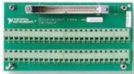
GRÁFICO 6.2 GRÁFICA CB-50LP, CONECTOR DE 50 PINES PARA CONEXIÓN DIRECTA
