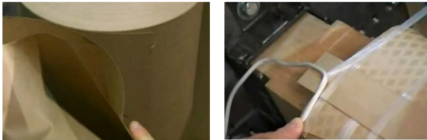
FIGURA 1.5 SISTEMAS DE AISLAMIENTO DE UN TRANSFORMADOR DE DISTRIBUCIÓN
