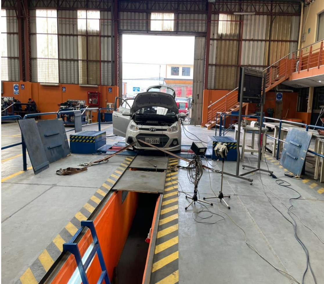
Figura A- 1: Prueba Banco Dinamométrico vehículo A
