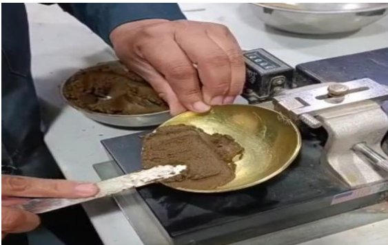
Figura 9. Ensayo Límite Líquido.
