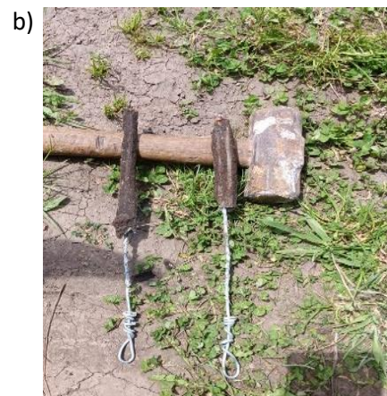
Figura 24. a) ensayo del anclaje, b) bulbos después del ensayo.
