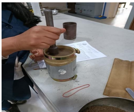
Figura 12. Compactación muestra Pujilí.
