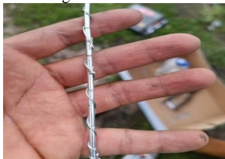
Figura 20. Anclaje de acero.
