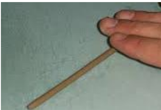
Figura 10. Ensayo Límite Plástico.
