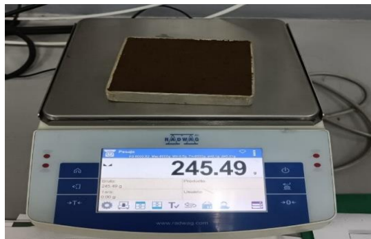
Figura 15. Muestra de suelo para ensayo de corte directo.
