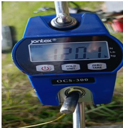
Figura 25. Ensayo anclaje Quito a 1.50 m de altura
