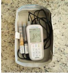
Equipo para medir pH, conductividad y temperatura
