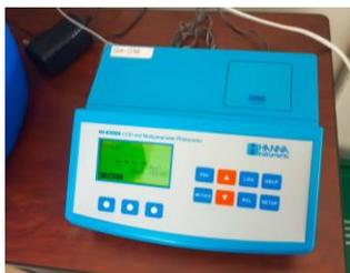
Equipo para medir Fosfatos, DQO, DBO5
